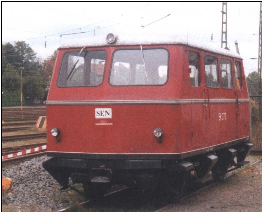
Großdraisine der Baureihe KlV 10, Typ S 17 H-0.0-20, „Schwer-Rottenkraftwagen zur Personenbeförderung“, Betriebsnummer 373 bei Fa. Eisenbahn und Häfen (1981).
